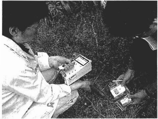
図4 放射線の測定(固定測定: 地表面)
